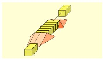
Die Rampe an den Enden der Mauer: Sie benötigt wenig Material, hat jedoch den Nachteil, dass die Steine über die ganze Mauerkrone gezogen werden müssen und dass dadurch weniger Arbeitskräfte eingesetzt werden können.
