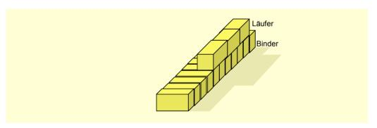
Die Läufer- und Binder-Methode: Das wechselweise Verlegen von Mauersteinen erhöht die Stabilität der Mauer.
