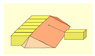
Die Rampe an der Stirnseite der Mauer: Sie benötigt zwar mehr Material, es können aber wesentlich mehr Arbeitskräfte eingesetzt werden.
